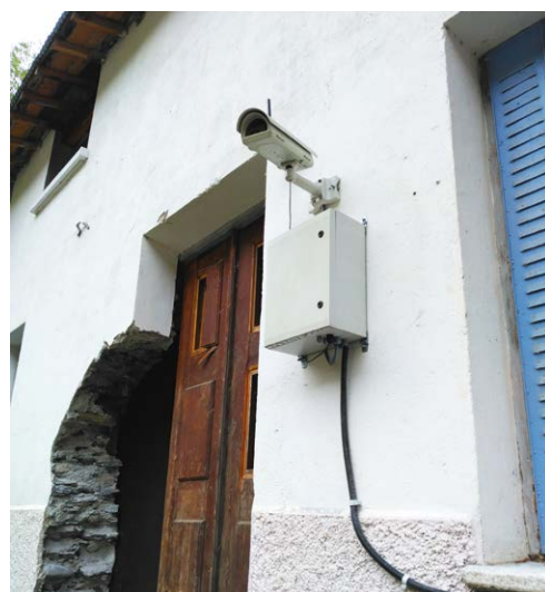
ÉCHELLE LIMNIMÉTRIQUE ET LA CAMÉRA DE SUIVI DU NIVEAU D'EAU JUSTE EN FACE
