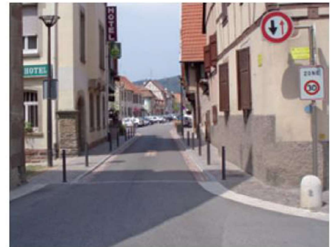
Elle peut avoir d'autres fonctions. Par exemple, ici elle assure la continuité des cheminements piétons lorsque ponctuellement l'emprise n'autorise pas deux voies de circulation et deux trottoirs.
